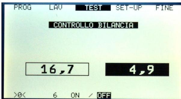
Come al solito si userà il valore di sinistra per verificare il corretto funzionamento della Cella di Carico, dei Cavi e degli Amplificatori con l'aiuto di un Peso che verrà caricato e tolto dalla bilancia più volte in modo da verificare la ripetibilità dei valori.
